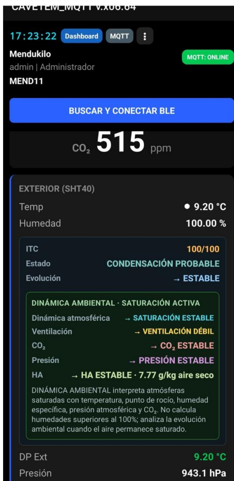
Figura 2. Dos situaciones de lectura dinámica: ABISMO022 como zona de transición próxima a saturación en Cueva del Puerto y MEND11 como ejemplo de atmósfera fría saturada en Mendukilo, donde la HR alcanza 100 % pero la interpretación depende de T, DP, CO 2 , presión y HA.
