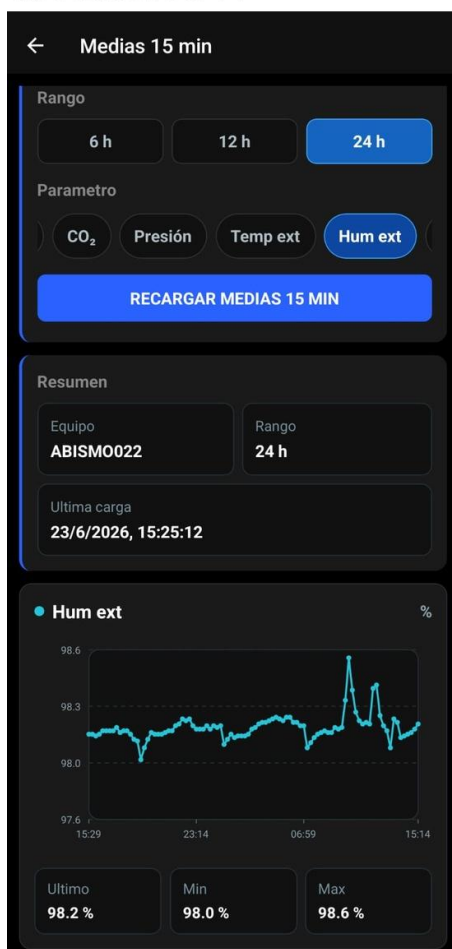
Figura 2. Dos situaciones de lectura dinámica: ABISMO022 como zona de transición próxima a saturación en Cueva del Puerto y MEND11 como ejemplo de atmósfera fría saturada en Mendukilo, donde la HR alcanza 100 % pero la interpretación depende de T, DP, CO 2 , presión y HA.
