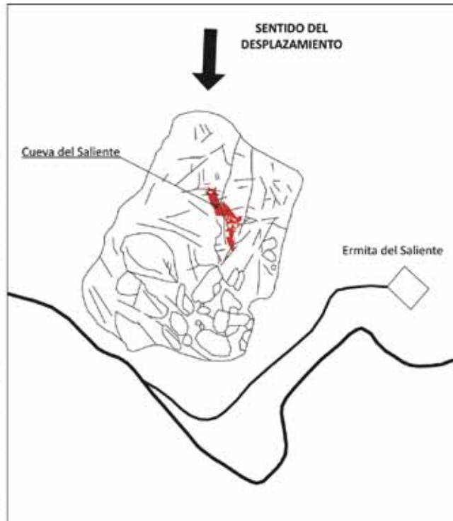
Figura 14. Deslizamiento del cerro de la Ermita. Izquierda: Ortophoto 2011. Derecha: Esquema que muestra las líneas de fractura principales y la compartimentación en bloques en el frente de desplazamiento. Se incluye también la planta de la Cueva del Saliente.
