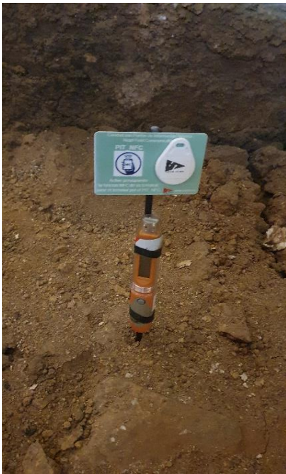
Foto 6. Punto de medición permanente dataloger y Punto NFC de información inteligente.
