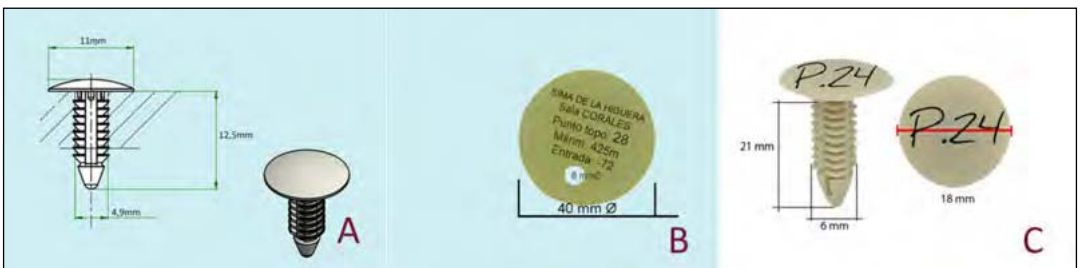
Figura 2. A: grapa estriada de 12,5mm. B: topo Point 41.25, etiqueta en vinilo para punto topográfico con datos, 40 mm de diámetro. C: topo Trans, grapa estriada de 21 mm de longitud para punto de transición.
