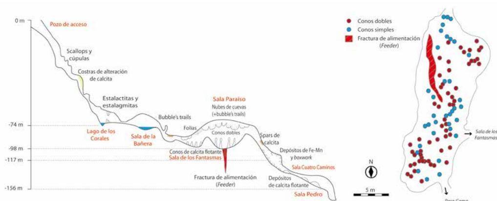
Figura 2. A. Ubicación de los principales elementos morfológicos y espeleotemas de la Sima de la Higuera sobre un alzado topográfico de la cavidad; B. Vista en planta de la Sala Paraiso y ubicación de los conos de calcita flotante simples (azul, n = 38) y dobles (rojo, n = 56).
