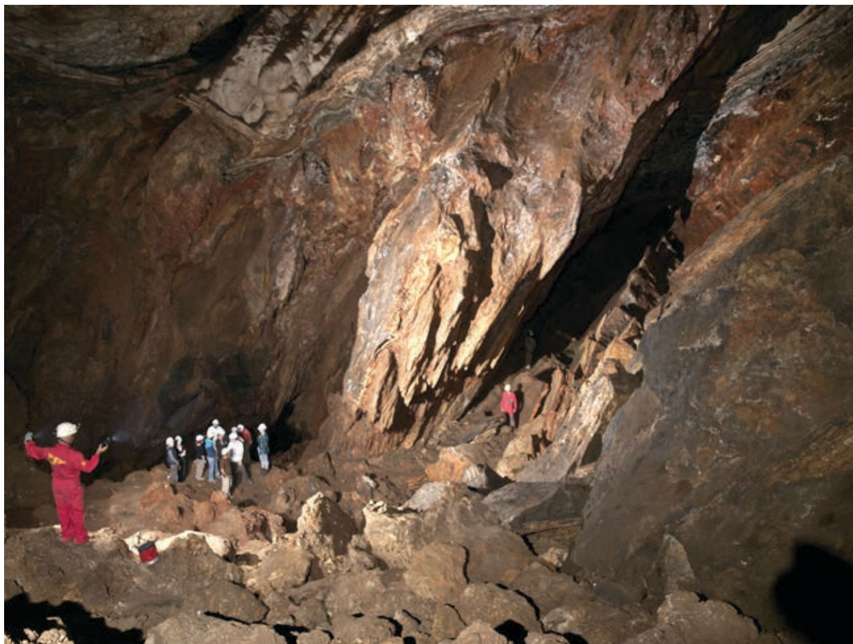
Fig. 12. Sala de la Goma, con unas dimensiones de 90 x 20 x 30 m de ancho esta sala es la de mayor tamaño de toda la cavidad. La actividad minera en esta sala fue intensa, se observan grandes bloques caídos del techo por acción de la minería y suelos naturales colgados a más de 10 m de la base de sala producto de la actividad extractiva. Existen grandes pozos por donde se transportaba el mineral al exterior.
