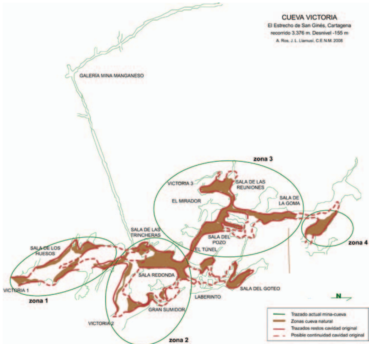
Fig. 4. Topografía de Cueva Victoria. La cavidad se dividió en cuatro grandes zonas para su reconstrucción. En gris aparecen marcadas las zonas donde se conservan vestigios de la cavidad natural original, la superficie en blanco indica nuevas galerías producto de la actividad minera.
