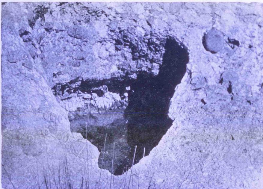
FOTO VII.—Detalle de una perforación, donde se aprecia su contenido en agua que evacua en profundidad (Foto Valenzuela)
